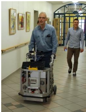
Abb. 8: Halb Roboter, halb Rollator: Diese Gehhilfe der Zukunft wird im AGAPLESION BETHANIEN KRANKENHAUS HEIDELBERG unter der Leitung von Professor Klaus Hauer im Rahmen eines von der Europäischen Union finanzierten Forschungsprojektes mitentwickelt und getestet.
